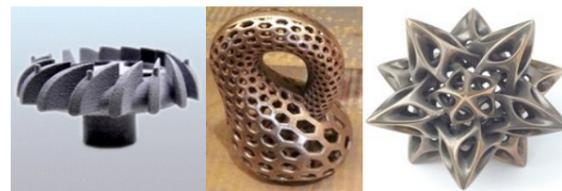
图6. SLS打印案例
