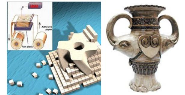
图8. LOM原理图和打印案例
